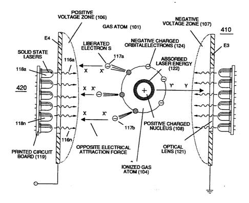
FIGURE 3-33: GAS PROCESSOR
