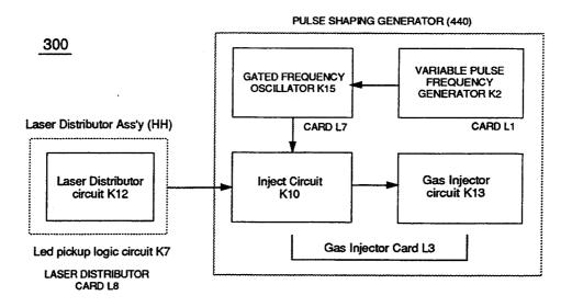
FIGURE 3-4: INJECTOR CONTROL CIRCUIT
